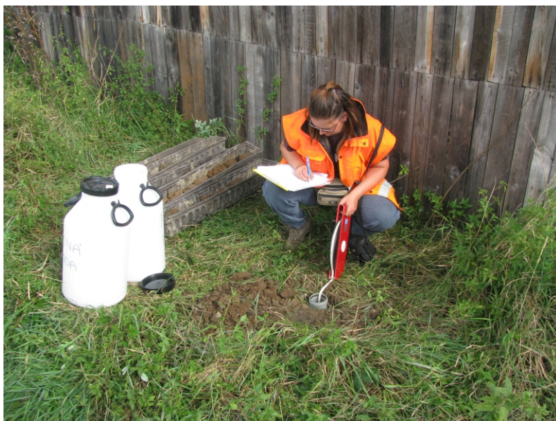
realizace nálevové vsakovací zkoušky ve vrtu J1
