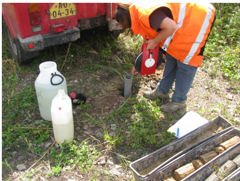
měření poklesu hladiny ve vrtu J3
