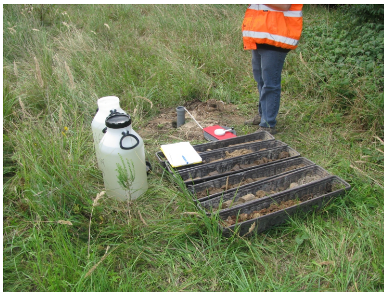
vsakovací zkouška ve vrtu J2
